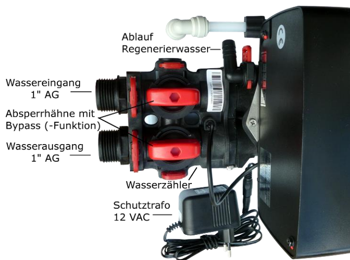
Abbildung 8: Anschlusskizze Steuerventil B 165
